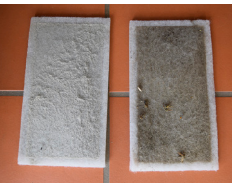
Zustand von Abluft- und Zuluftfilter nach sechs Monaten Betriebszeit (oben); einfacher Filterwechsel: alten Filter herausziehen und den neuen Filter einschieben (rechts)
